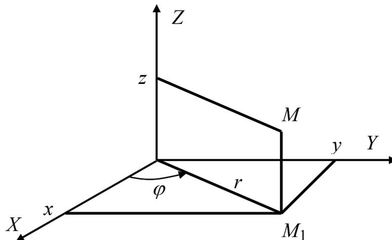
Рис. 11. Цилиндрические координаты.
